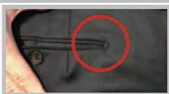
ジャケット・パンツのポケットをD門(カン)留めで強度加工を施します
